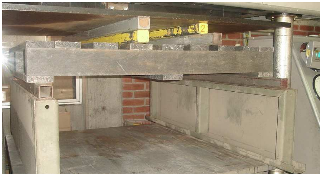
Figura A1. Montaje de pallet para ensayo de ruptura por flexión, lado de 1.200 mm.
