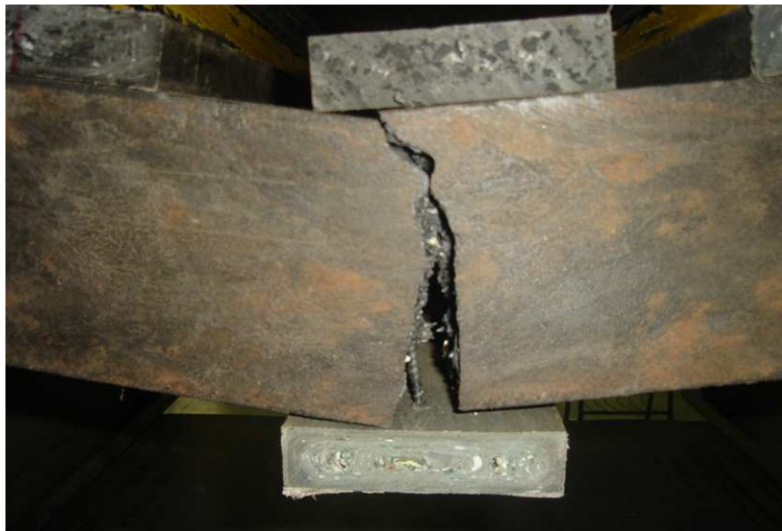
Figura A3c. Ruptura por flexión, lado de 1.200 mm.
