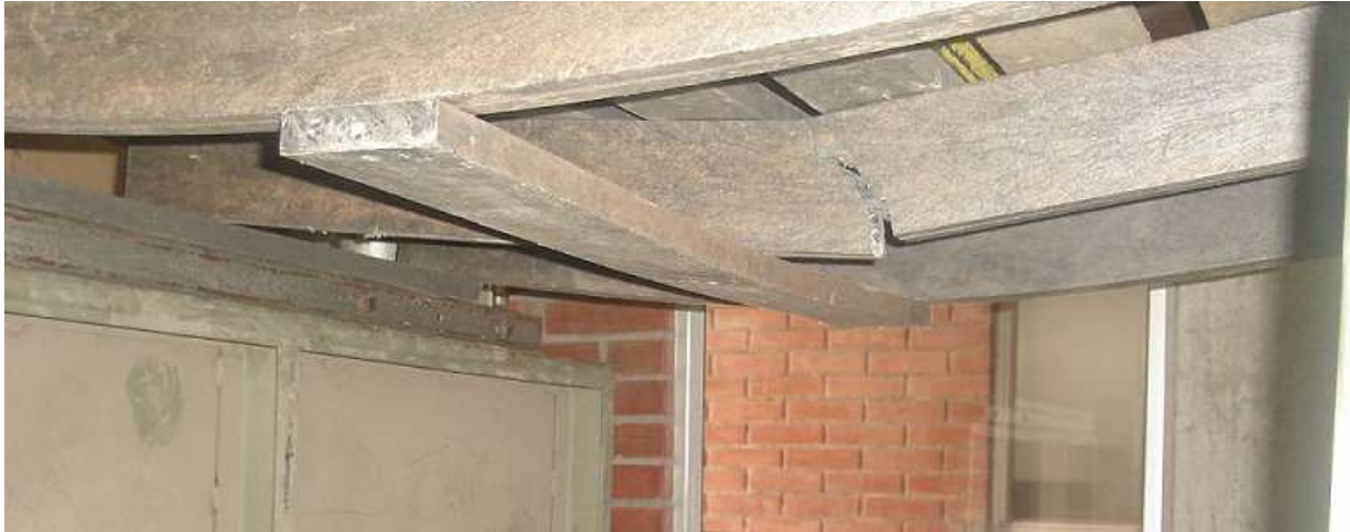
Figura A3a. Ruptura por flexión, lado de 1.200 mm.
