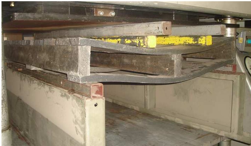
Figura A5. Comportamiento a la flexión, lado de 1.000 mm.
