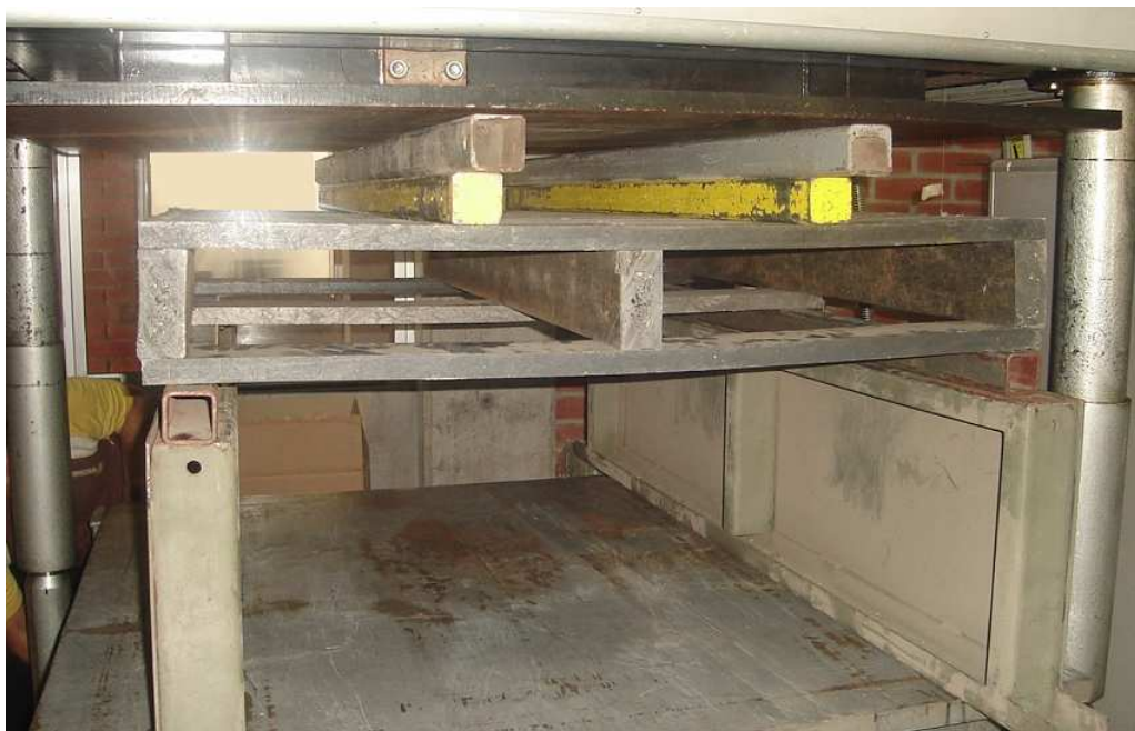
Figura A4. Montaje de pallet para ensayo de ruptura por flexión, lado de 1.000 mm.
