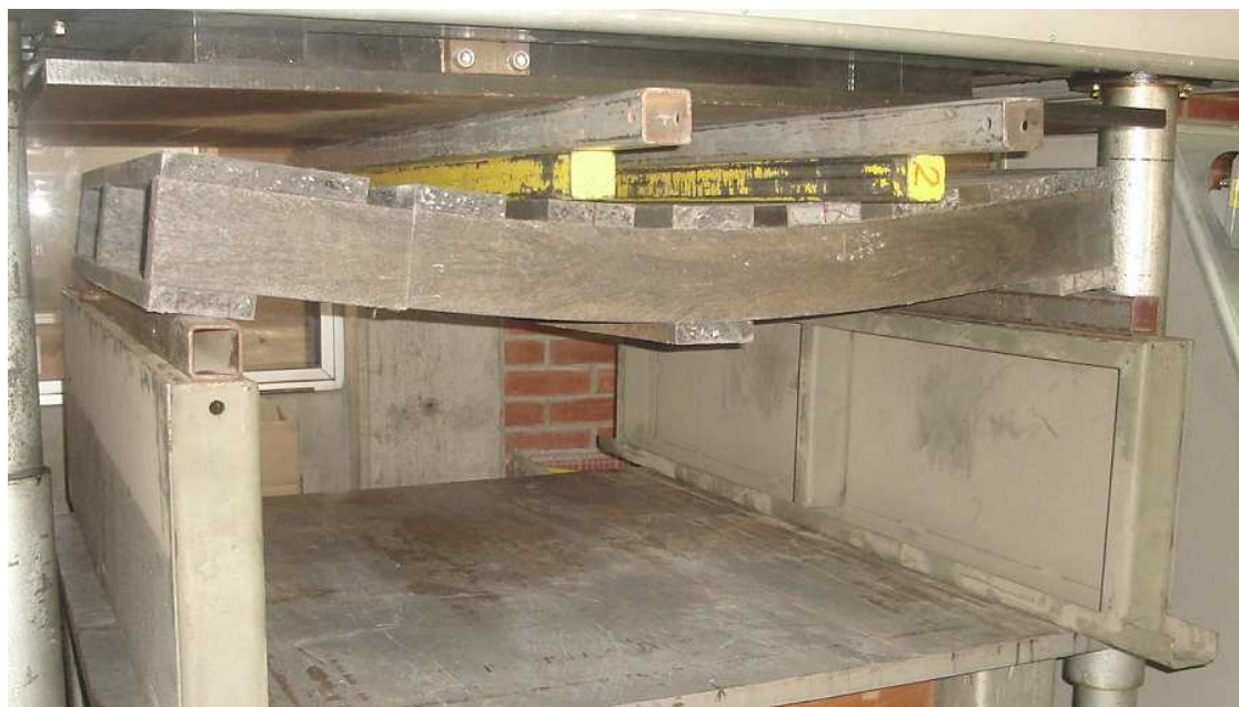
Figura A2. Comportamiento a la flexión, lado de 1.200 mm.
