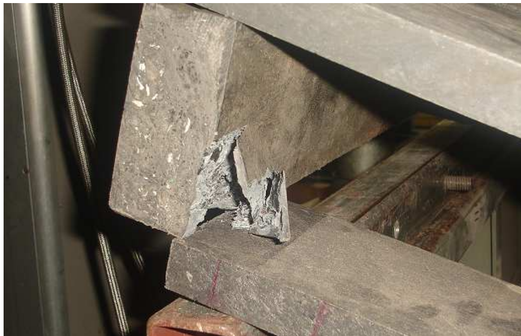
Figura A6b. Ruptura por flexión, lado de 1.000 mm.
